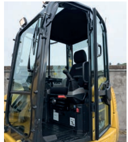
Neue klappbare Tür für besseren Zugang
